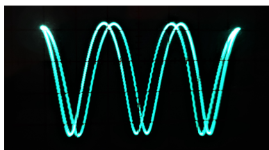
Рис. 6: Фигура Лиссажу для U_0 = 3U_{\lambda/2}
