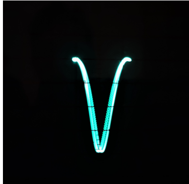
Рис. 4: Фигура Лиссажу для U_0 = U_{\lambda/2}
